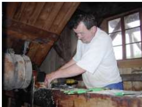
Unser Vereinsobmann bei Arbeiten am Holzlager des Grindelbaumes
