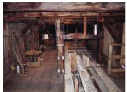
Das Sägegatter mit dem Blochwagen im Vordergrund
