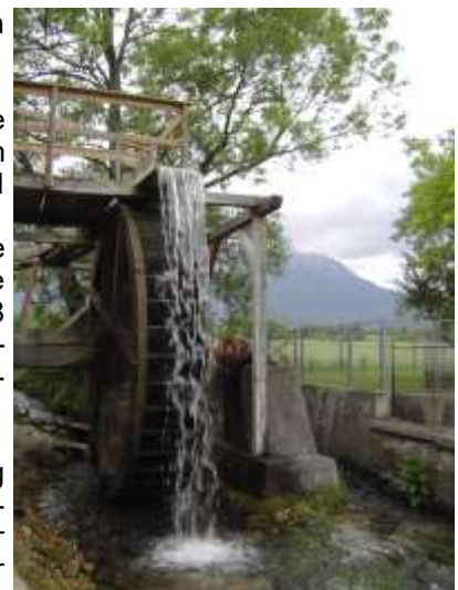
Wasserrad mit einem Durchmesser von ca. 3,8 Meter
